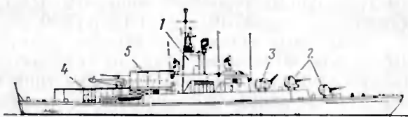
Рис. 9. Фрегат «Бергамини»: 1 — мачтотруба; 2 — одноорудийные 76-мм башенные артиллерийские установки; 3 — одноствольный бомбомет; 4 — взлетно-посадочная площадка для вертолета; 5 — ангар
