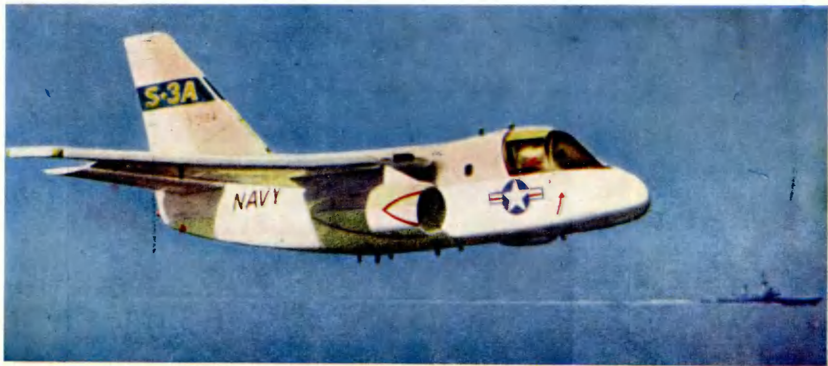
АМЕРИКАНСКИЙ ПАЛУБНЫЙ ПРОТИВОЛОДОЧНЫЙ САМОЛЕТ S-3A «ВИКННГ». Находится на вооружении с 1974 года. Экипаж четыре человека, максимальный взлетный вес 19 250 кг, максимальная скорость полета 800 км/ч, скорость патрулирования 255 км/ч, практический потолок 10 675 м, дальность полета 3700 км (перегоночная), размах крыла 20,9 м, длина самолета 16,3 м, высота 6,9 м. Вариант вооружения: четыре бомбы Mk 36, две глубинные бомбы Mk 57, четыре торпеды Mk 46 (в двух бомбовых отсеках); две пусковые установки с семью или 19 НУР калибра 70 мм, четыре НУР калибра 127 мм и мины Mk 52 (на двух подкрыльевых пилонах). Самолет оснащен радиогидроакустическим оборудованием, ИК системой переднего обзора, магнитным обнаружителем и средствами радиоэлектронного подавления.
