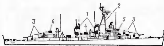
Рис. 7. Эскадренный миноносец типа «Флетчер»: 1 — дымовые трубы; 2 — треножная мачта; 3 — одноорудийные 127-мм башенные артиллерийские установки; 4 — 76-мм артиллерийские установки; 5 — бомбометы
