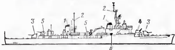
Рис. 5. Эскадренный миноносец «Сан Джорджио»: 1 — дымовые трубы; 2 — мачты; 3 — двухорудийные 127-мм башенные артиллерийские установки; 4 — трехствольный бомбомет; 5 — одноорудийные 76-мм башенные артиллерийские установки; 6 — трехтрубный торпедный аппарат
